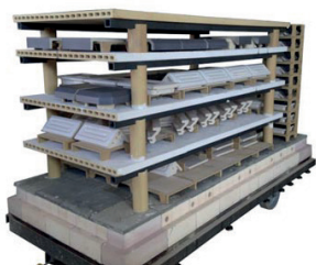
Plaques endurées (plaques creuses) 1850 x 850 x 38 mm
